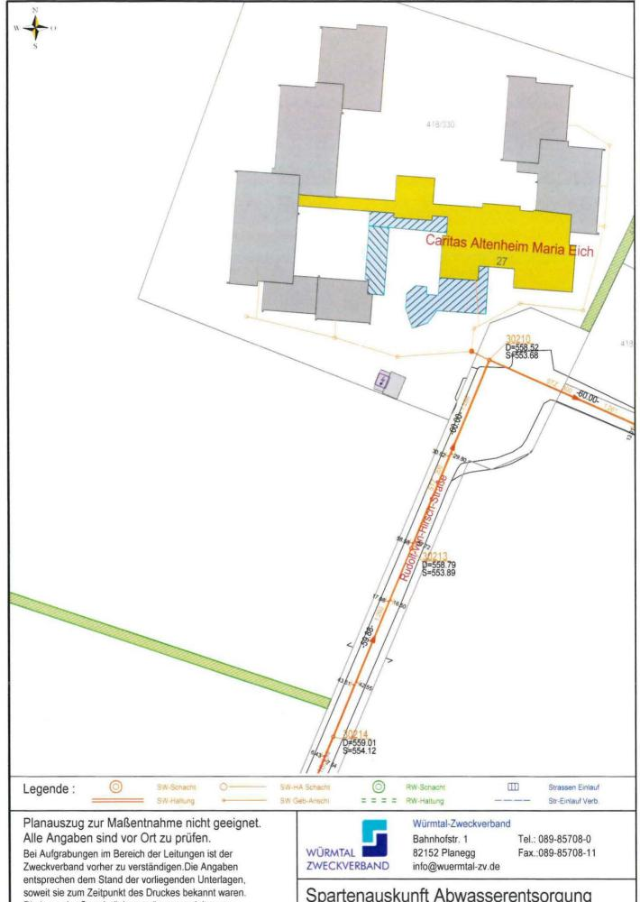
Bei Aufgrabungen im Bereich der Leitungen ist der Zweckverband vorher zu verständigen. Die Angaben entsprechen dem Stand der vorliegenden Unterlagen, soweit sie zum Zeitpunkt des Druckes bekannt waren. Die Lage der Grundstücksentwässerungsleitungen dienen der Übersicht und sind lageungenau. Die Angaben zu Grundstücks- u. Gebäudegrenzen beruhen auf Nutzung der Geobasisdaten © Bayerische Vermessungsverwaltung 2019. Sämtliche Informationen dürfen nur für den eigenen Bedarf genutzt werden.
